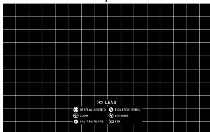
Pulse **▲, ▼, ◀ o ▶** en el proyector o en el mando a distancia para ajustar la posición de la imagen.
