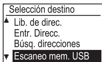
Seleccione "Escaneo mem. USB" con la tecla [▼] y pulse [OK].
