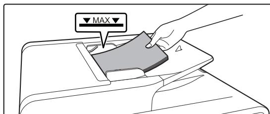
**Coloque el original en la bandeja del alimentador de documentos automático.**
