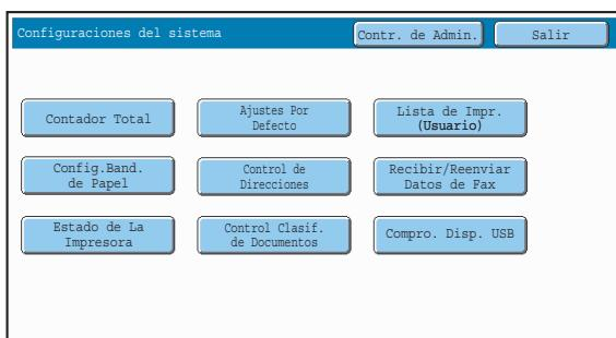
Compruebe que la máquina está en estado de espera y pulse la tecla [SISTEMA AJUSTES] del panel de funcionamiento.
