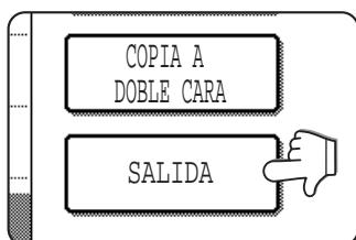
Cuando se detecta un documento en el cristal para documentos, se seleccionará automáticamente el modo de grupo. Para seleccionar la con ordenación, pulse la tecla [SALIDA], después la tecla [ORDENAR] de la pantalla visualizada, y, finalmente, la tecla [OK].
