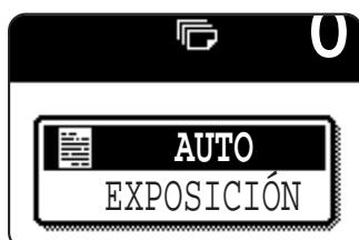
El modo automático de exposición constituye la configuración inicial por defecto de esta máquina. En este modo, las características de un original que se está copiando son "leídas" por el sistema de exposición, y los ajustes de la exposición se realizan automáticamente. Para seleccionar un modo de exposición más adecuado a los originales a copiar, o para ajustar la exposición de forma manual, siga el procedimiento siguiente.
