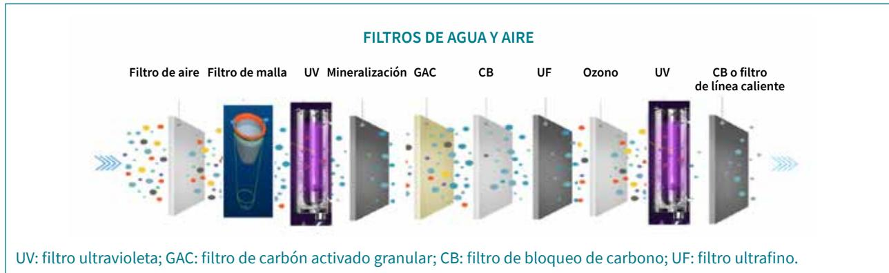
Skywell aspira aire ambiente y absorbe la humedad a través de la condensación. Tecnología avanzada de supervisión, en combinación con seis filtros, dos luces ultravioleta y un sistema de tratamiento del ozono garantizan la pureza de cada gota de agua. Además, el agua se verifica continuamente para garantizar su alta calidad, claridad y sabor.
