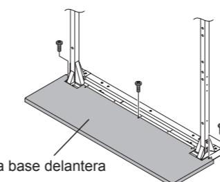
**3 Acople la placa base trasera y, a continuación, el ángulo de montaje de la tapa (izquierdo y derecho) con 9 de los tornillos M6 suministrados.**
