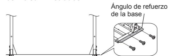
**2 Acople la placa base delantera con 3 de los tornillos M6 suministrados.**
