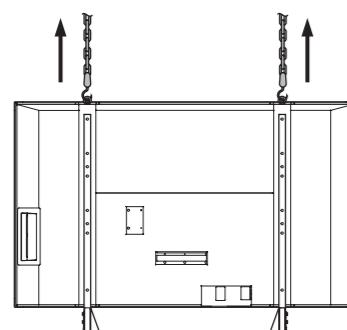
**3 Quite los pernos de montaje del soporte de la parte posterior y separe el Monitor LCD del soporte.**
