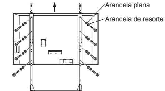
**7 Asegúrese de que el Monitor LCD queda montado de forma segura y, a continuación, retire los ganchos del dispositivo de elevación.**
