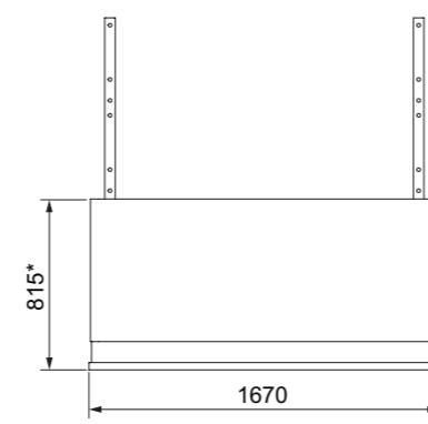
\* Altura cuando se efectúa el montaje a 1600 mm
