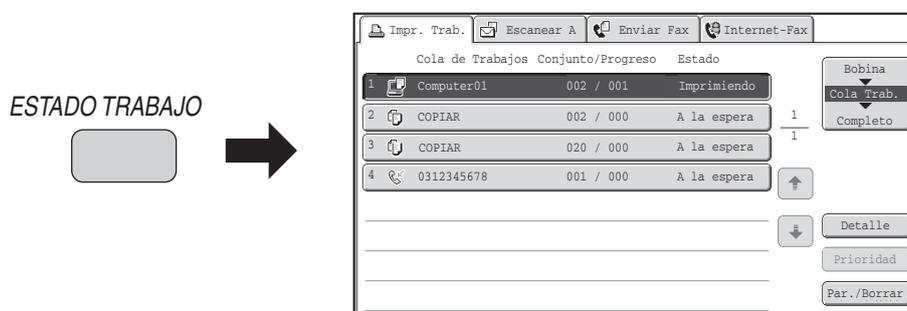
El estado del trabajo (A) se muestra en la parte inferior izquierda del panel de control. La pantalla de estado del trabajo se puede tocar para mostrar la pantalla de estado del trabajo. En la pantalla de estado de los trabajos (B), se pueden comprobar los cuatro primeros trabajos que están en la cola de impresión (el trabajo en curso y los reservados).
