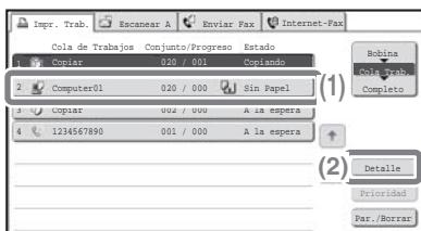
Pulse la tecla [ESTADO TRABAJO] en el panel de funcionamiento para mostrar la pantalla de estado del trabajo.
