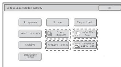
Si se toca una de las teclas de modo especial rodeada con [  ], dicha tecla queda resaltada y el ajuste se aplica.
