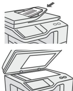
Si la dimensión X (ancho) del documento es inferior a 89 mm (3-1/2") o la dimensión Y (alto) es inferior a 100 mm (4"), coloque el original en el cristal de exposición. Si utiliza el alimentador de documentos automático, seleccione el "Modo de Escaneo Lento" para un original fino.
