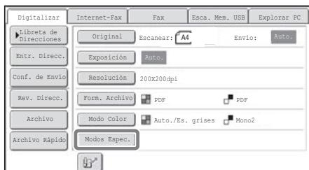
Para utilizar un modo especial, abra el menú de modos especiales y pulse la tecla del modo que desea usar. El menú varía en función de si se ha seleccionado modo de escaneo, fax de Internet o memoria USB.
