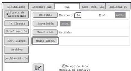
Para utilizar un modo especial, abra el menú de modos especiales y pulse la tecla del modo que desea usar. El menú se compone de dos pantallas. Utilice las teclas  $\leftarrow$   $\rightarrow$  para alternar entre las pantallas. Pulse la tecla [Modos Espec.] en la pantalla inicial para abrir el menú de modos especiales.
