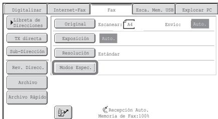
Para utilizar un modo especial, abra el menú de modos especiales y pulse la tecla del modo que desea usar. El menú se compone de dos pantallas. Utilice las teclas para alternar entre las pantallas. Pulse la tecla [Modos Espec.] en la pantalla inicial para abrir el menú de modos especiales.
